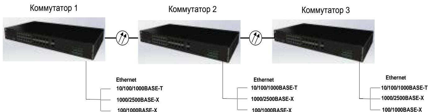
Рисунок 3 – Включение коммутаторов в кольцевую топологию
