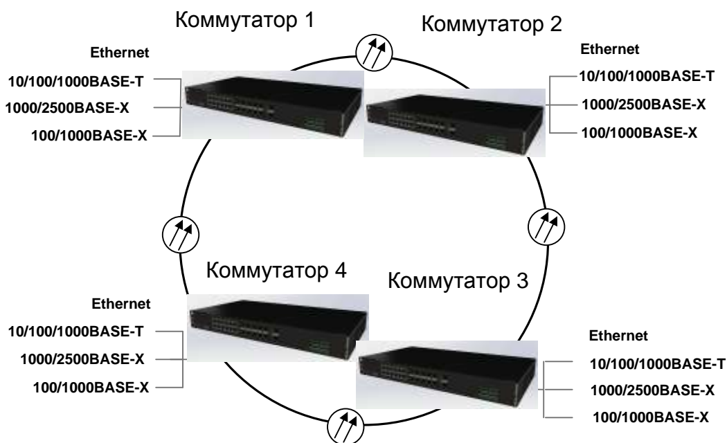
Рисунок 3 – Включение коммутаторов в кольцевую топологию
