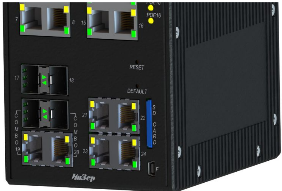
Рисунок 12 – Установка карты памяти в коммутатор
