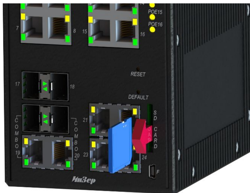
Рисунок 14 – Извлечение карты памяти из коммутатора
