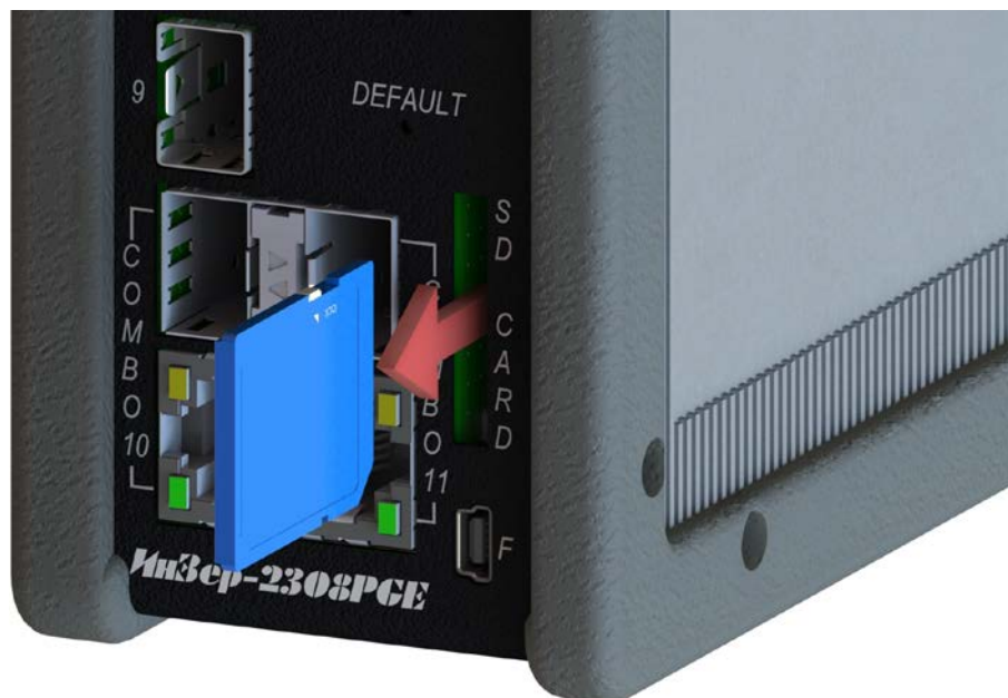
Рисунок 13 – Извлечение карты памяти из коммутатора
