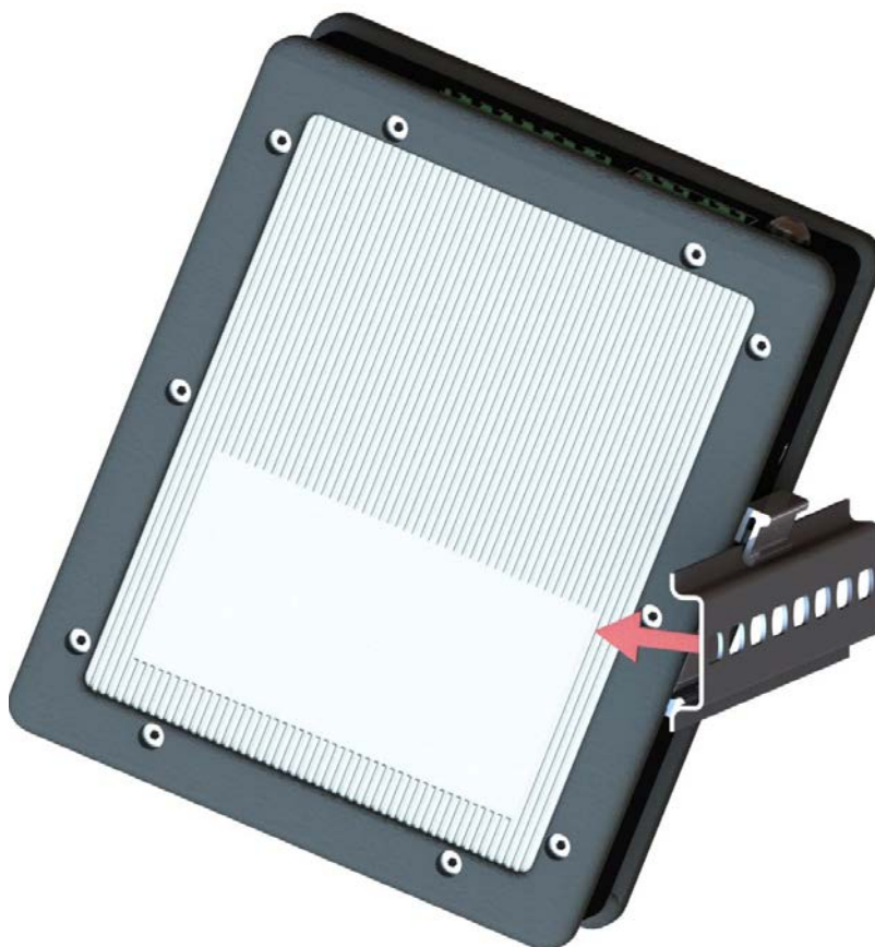
Рисунок 9 – Извлечение коммутатора из DIN-рейки
