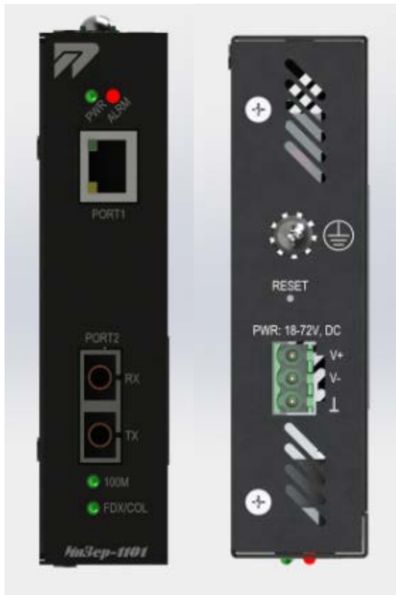
Рисунок Б.1 – Внешний вид лицевой и задней панелей медиаконвертера ИнЗер®-1101
